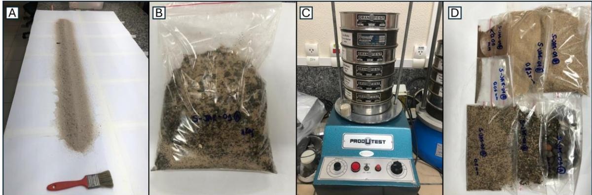
Figura 9: A) Etapa de quartamento da amostra S-JAR-01-A. B) Alíquota de 1 kg de amostra separada após etapa anterior. C) Etapa de peneiramento. D) Resultado da classificação granulométrica.
