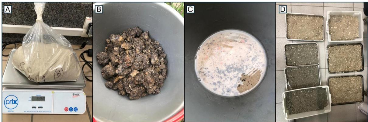
Figura 8: A) Etapa de pesagem das amostras. B) Amostra S-JAR-01-A antes do método de lavagem. C) Amostra S-JAR-01-A após lavagem. D) Etapa de secagem ao ar livre das amostras utilizando bandejas de metal e plástico.
