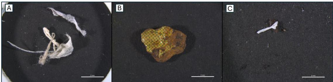
Figura 43: Microplásticos do ponto S-BAC-01. A) Fibras brancas na amostra S-BAC-01-A 2mm. B) Fragmento em S-BAC-01-B 2mm. C) Fibra branca em S-BAC-01-B 0,250 mm.
