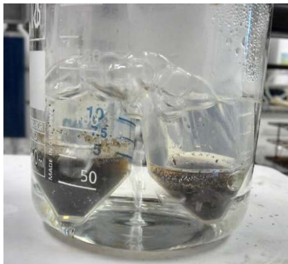
Figura 10: Tratamento das fibras de coco e sisal com diferentes solventes
