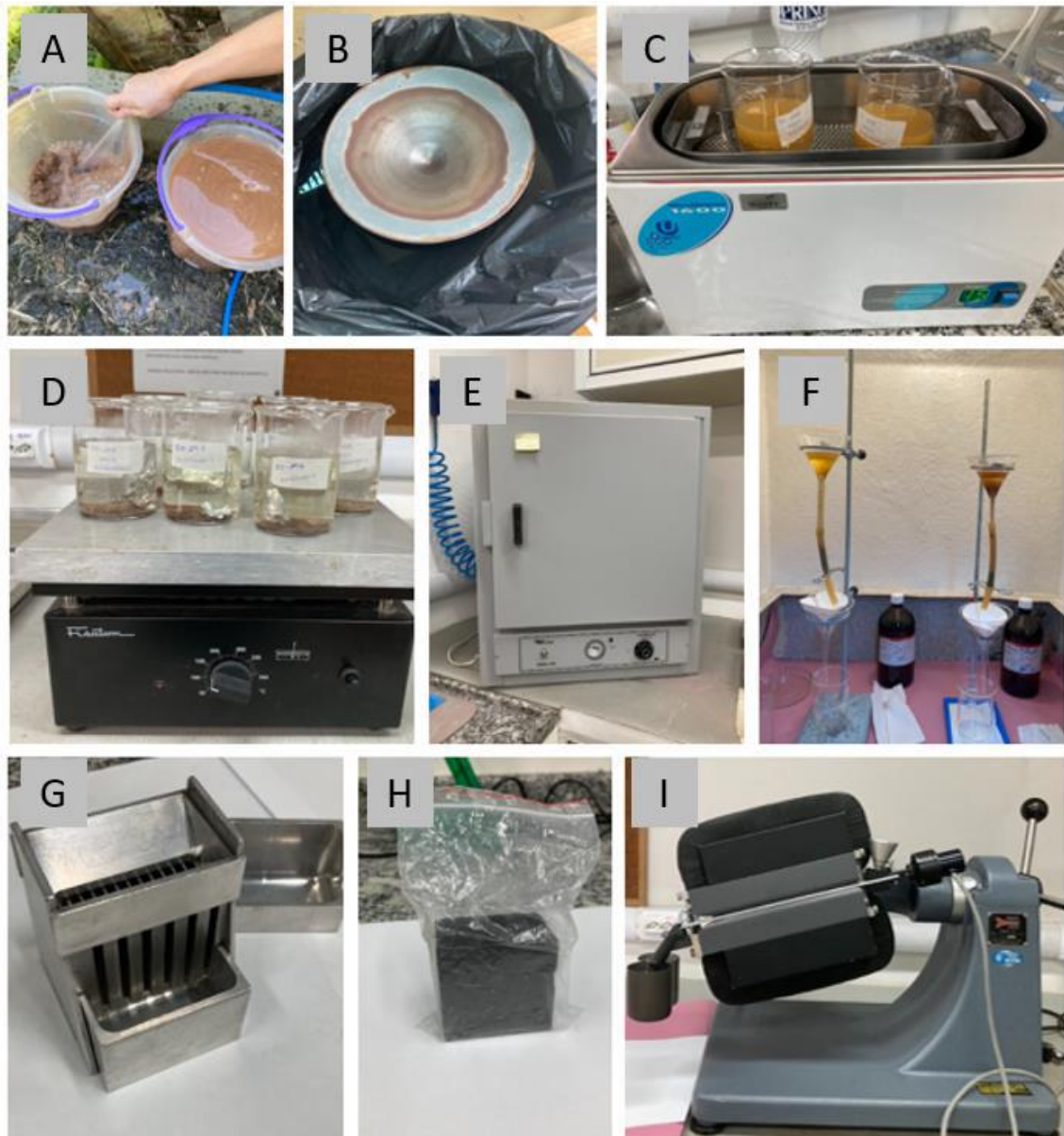
Figura 3: Etapas do preparo das amostras para descrição dos minerais em grãos. (A) Deslamagem; (B) Bateia; (C) Ultrassom; (D) Reação com ácido oxálico; (E) Estufa; (F) Bromofórmio; (G) Quarteador; (H) Imã de ferrite; (I) Separador isodinâmico Frantz.
