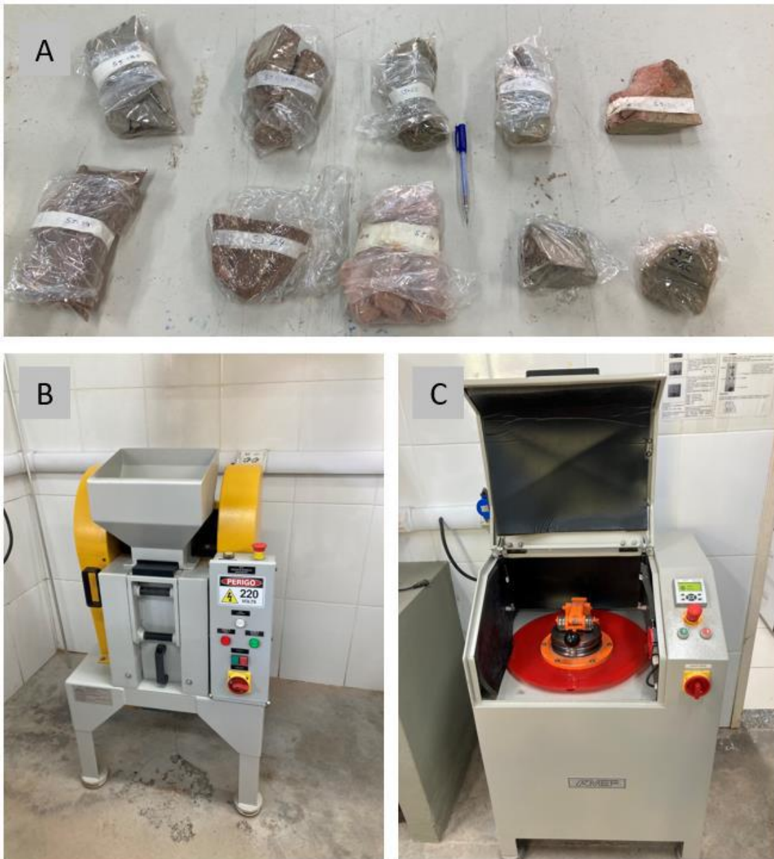
Figura 4: Etapas do preparo das amostras para análise de difração de Raios-X e litogeoquímica. (A) Amostras analisadas; (B) Britador de mandíbulas; (C) Moinho pulverizador de panela.
