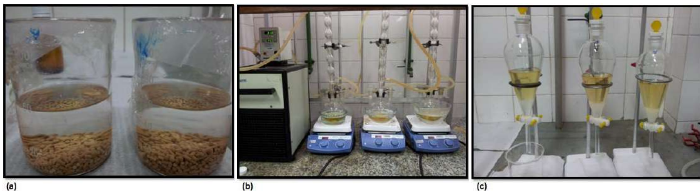
Figura IV-3 Etapas da síntese: (a) Preparo do catalisador, (b) Reação de transesterificação e (c) Purificação do biodiesel etílico.
