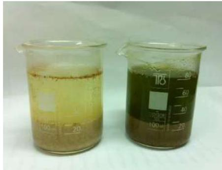
**Figura 10.1 – Etapa de decantação do teste de detecção de clorofila.**
