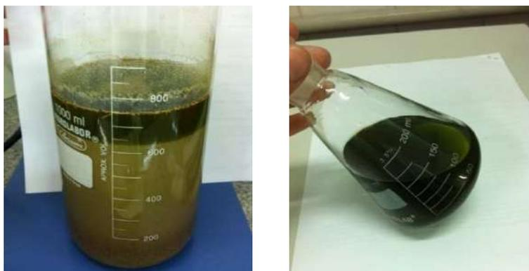
**Figura 10.4 – Etapa de decantação e filtrado do ensaio com duas lavagens com álcool etílico (resultados após a segunda lavagem).**
