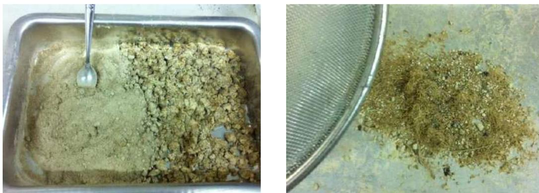
**Figura 10.8 – Pó de palha (P<sub>2</sub>) após etapa de secagem e resíduos peneira.**
