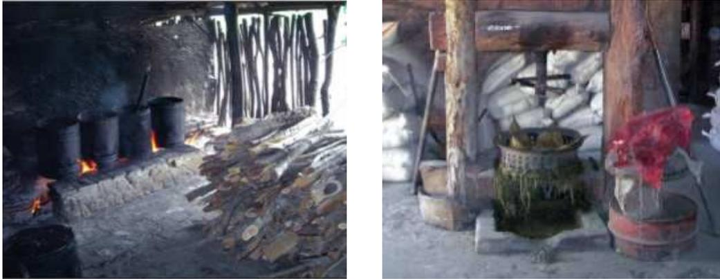
**Figura 5.12 – Recozimento em latas de querosene e filtração (prensa).**
