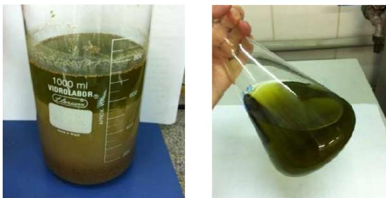
**Figura 10.5 – Etapa de decantação e filtrado do ensaio com três lavagens com álcool etílico (resultados após a terceira lavagem).**
