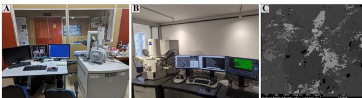
Figura 14 – Microscópio eletrônico de varredura e periféricos. A) Equipamento FEI Quanta 400 , com espectrômetro Bruker Quantax 800 , detector XFlash 5010 . B) Equipamento Zeiss Sigma 300 VP (field emission gun) com 2 detectores EDS Bruker Nano Quantax 400 . C) Imagem de elétrons retroespalhados.
