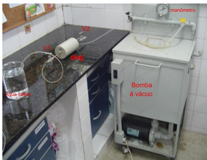
Figura 3.8: Sistema de saturação dos plugs de rocha contidos nas células de teste
