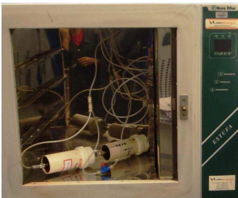
Figura 3.9: Células de teste posicionadas em série no interior da estufa para os ensaios de eluição
