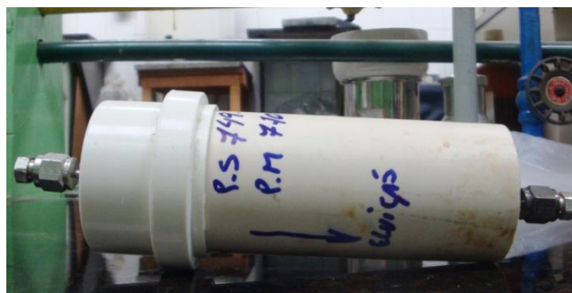
Figura 3.7: Célula de teste utilizada nos ensaios de eluição
