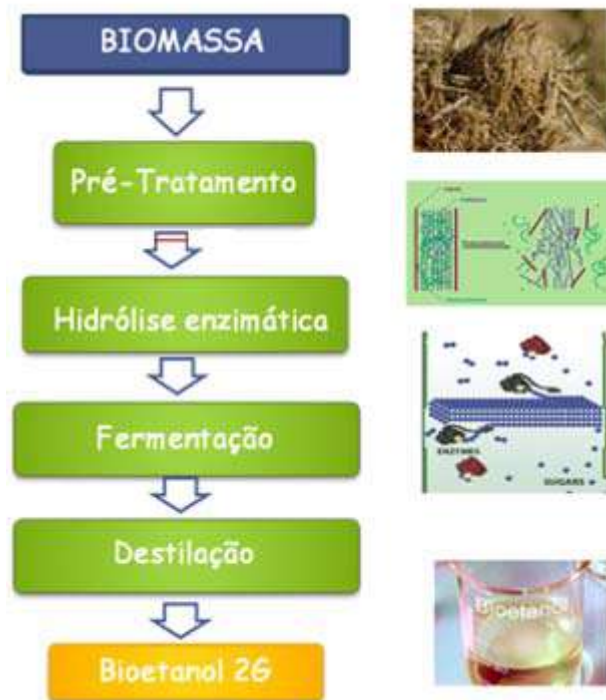
Figura 13. A rota tecnológica para produção de etanol de segunda geração. (Adaptado de BASTOS, 2007)
