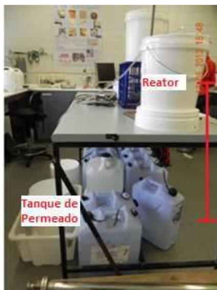
Figura 27: Posicionamento do T3 (tanque permeado) em relação ao T2 (reator)
