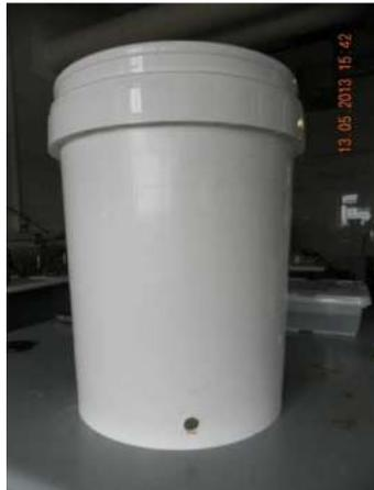
Figura 20: Tanque de alimentação(T1)
