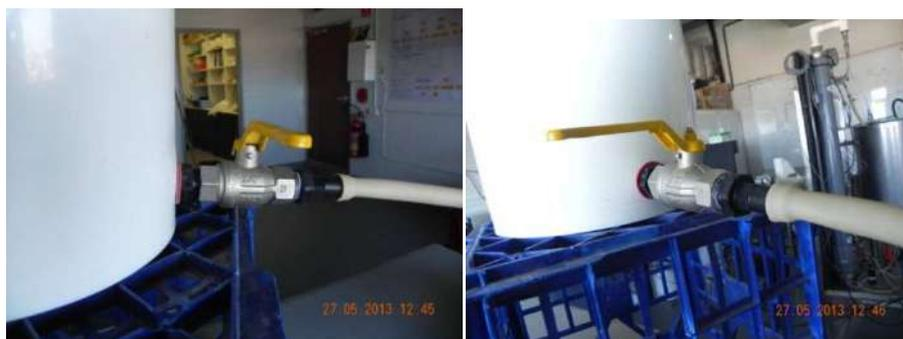
Figura 21: Tanque de alimentação (T1) com conexão e válvulas
