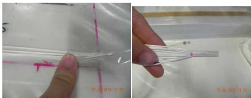
Figura 9: Aspecto final das Fibras de membrana alinhadas e agrupadas.
