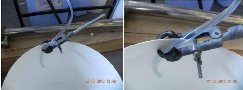
Figura 28: Fixação tubo coletor de permeado com garra
