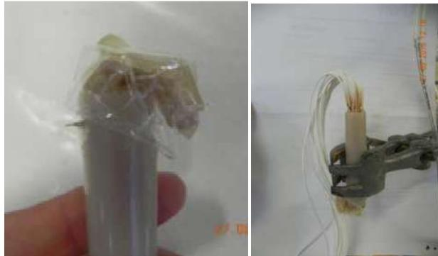
Figura 14: Selagem do tubo e secagem
