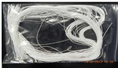
Figura 7: Amostra de Membranas de fibra oca
