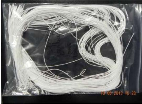
Figura 2. Membrana de fibra oca do modulo
