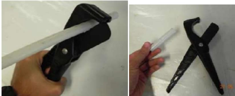
Figura 10: Corte do tubo no qual as membrana serão alocadas.
