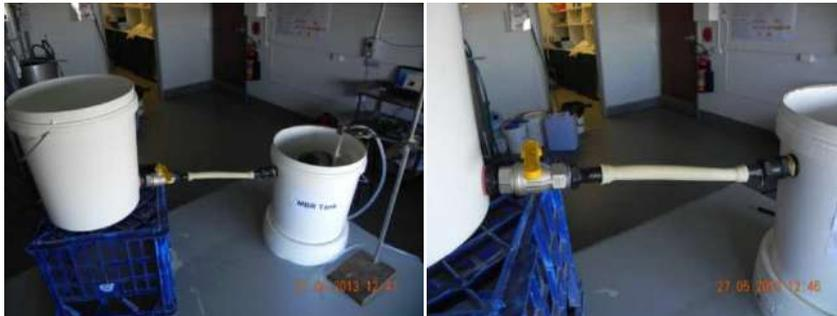
Figura 22: Posicionamento do tanque alimentação (T1) e tanque reator(T2)
