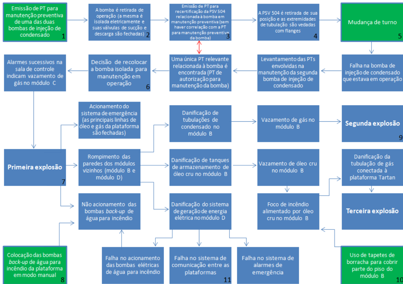
Figura VI.1 – Sequência de eventos que resultou na destruição da plataforma Piper Alpha
