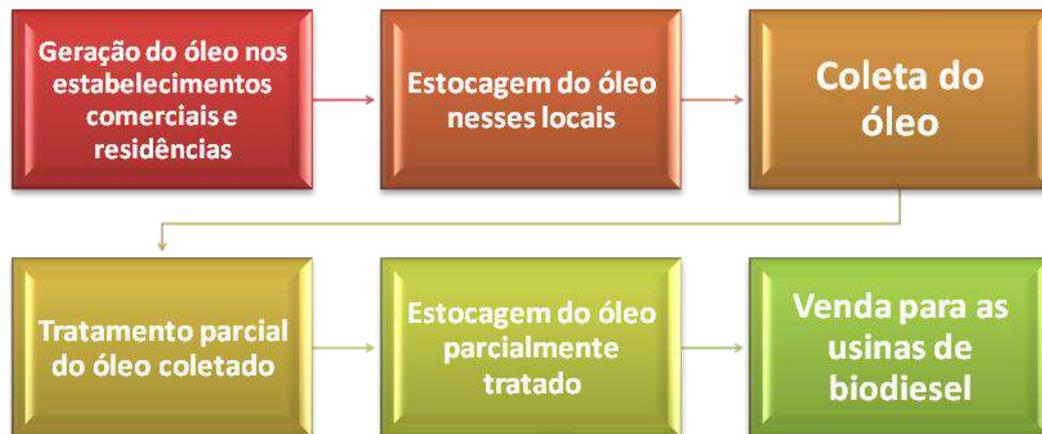
Figura 11 - Diagrama de blocos geral da logística reversa do óleo de fritura residual
