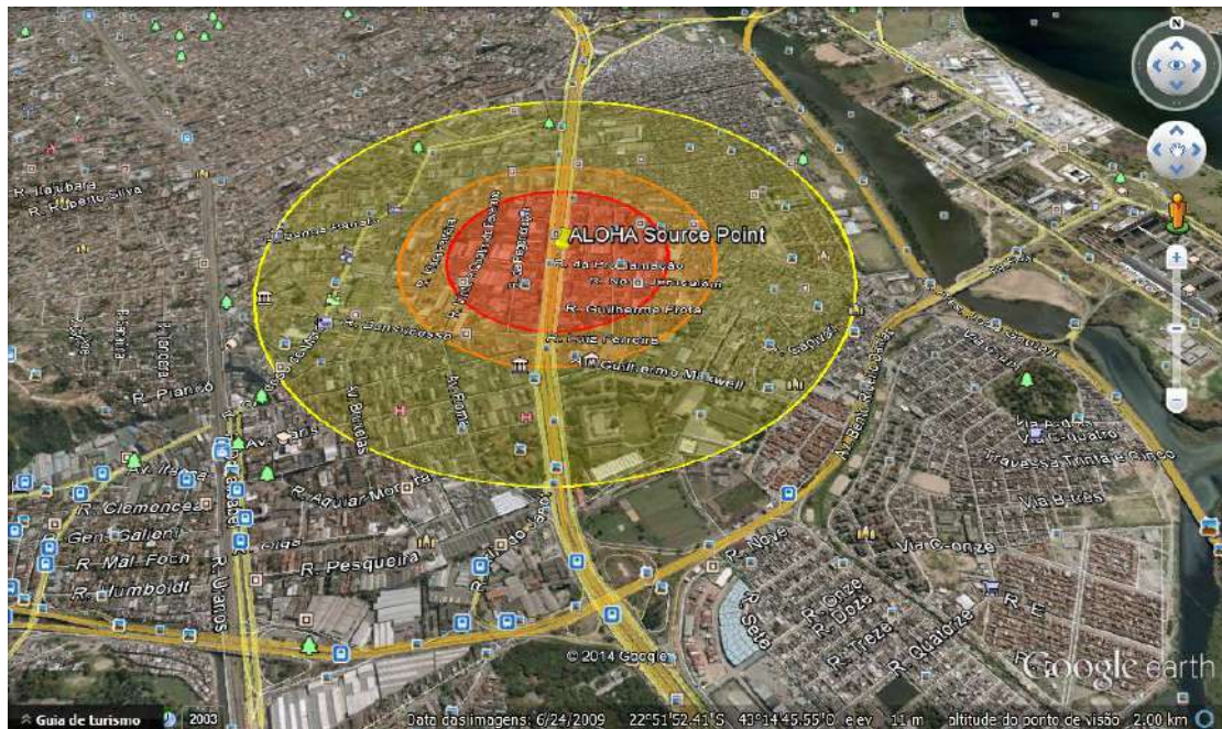
Figura 4-5: Zonas de impacto calculadas pelo ALOHA para os níveis de radiação 1,4 \text{ kW/m}^2 (amarelo), 5 \text{ kW/m}^2 (laranja) e 10 \text{ kW/m}^2 (vermelho), para o Cenário 1. Fonte: adaptado de Google Earth, 2014.
