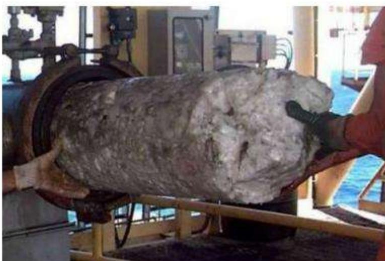
Figura 2.2 – Grande entupimento de hidrato de gás formado numa tubulação de hidrocarbonetos da Petrobrás (web).
