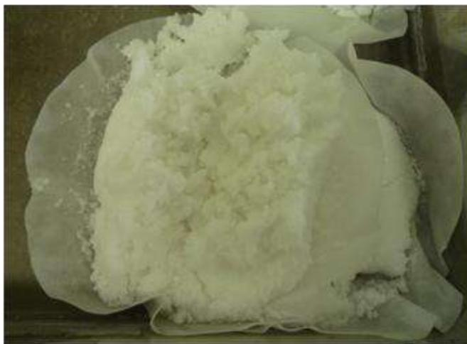
Figura XXI – Hidróxido de lítio cristalizado após evaporação e resfriamento da lixívia
