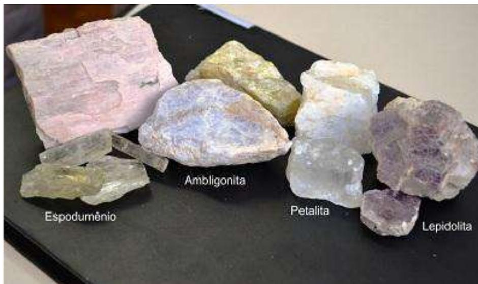
**Figura III – Minerais litíferos com valor comercial. Fonte: CPRM**
