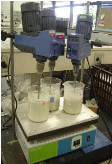
Figura XIX – Ensaio de lixiviação a quente em laboratório
