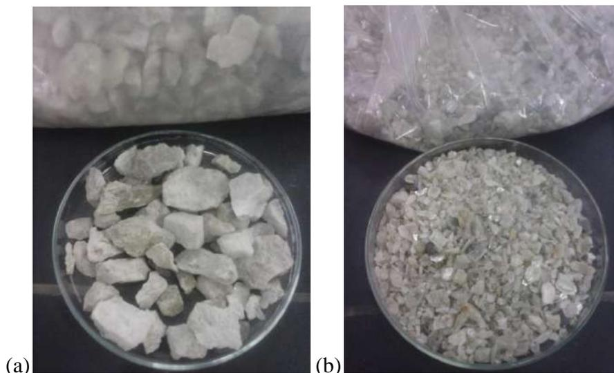
Figura XI – (a) Concentrado recebido (-6 mm) e (b) concentrado britado (-2 mm)
