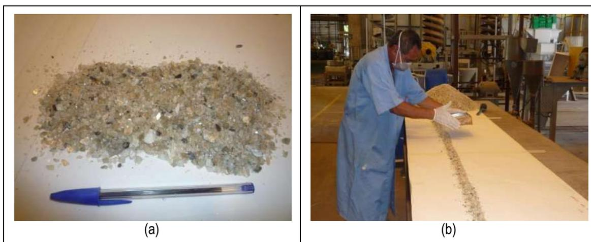
Figura XII – (a) Amostra de concentrado de espodumênio; (b) homogeneização e coleta de alíquotas (Braga e França, 2012)
