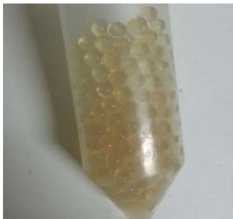
Figura 14 - Esferas contendo HRP após 120 minutos de imobilização (Próprio autor, 2014).
