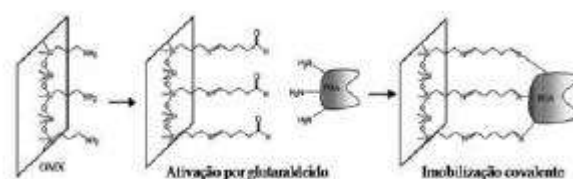
Figura 10 - Imobilização covalente de Xerogel Organicamente Modificado (OMX) por multipontos [59].
