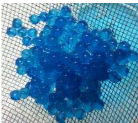
Figura 17 - Esferas de HRP imobilizada, após 240 minutos de reação com o azul de metileno (Próprio autor, 2014).
