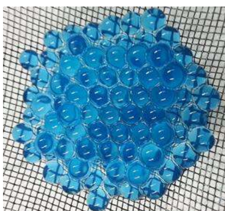
Figura 19 - Esferas de HRP imobilizada, após o 3º ciclo de reação com o azul de metileno (Próprio autor, 2014).
