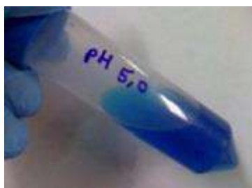
Figura 15 - Solução de corante azul de metileno com concentração de 15 mg/L em tampão fosfato pH 5,0 [17].
