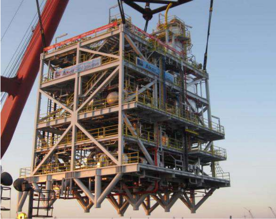
Figura 22 – Módulo offshore de Recuperação de MEG fornecido pela empresa Aker Solutions em Cidade de Santos. Fonte: Aker Solutions (2010)
