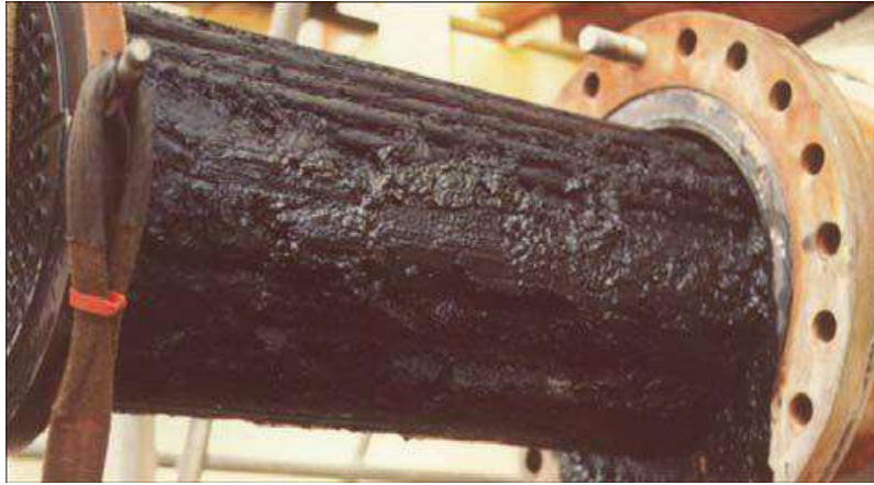
Figura 16 – Ilustração de deposição de sais em um trocador de calor, devido ao seu acúmulo no MEG Rico
