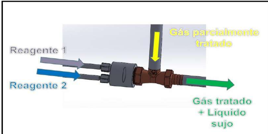
Figura 30: Lavador Venturi e seu funcionamento
