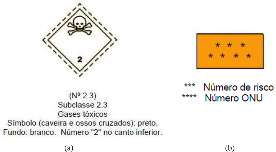
Figura 4.1 – Rótulo de identificação e painel de segurança para transporte de produtos perigosos da subclasse 2.3 Fonte: Resolução ANTT nº 420 (2004)
