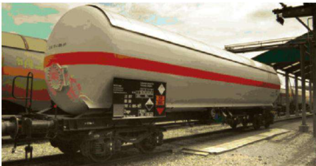
Figura 4.3 – Típico vagão-tanque para transporte de amônia. Fonte: EFMA (2007)
