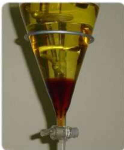
Figura 9 - Foto de um funil de separação contendo as duas fases líquidas formadas pela reação de transesterificação do sebo bovino
