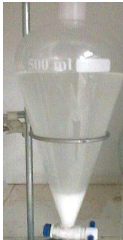
Figura 28 – Fotografia do processo de extração do biossurfactante. Funil de separação contendo: extrato concentrado/clorofórmio/metanol, na proporção de 1:8:8, com formação de precipitado branco no fundo.
