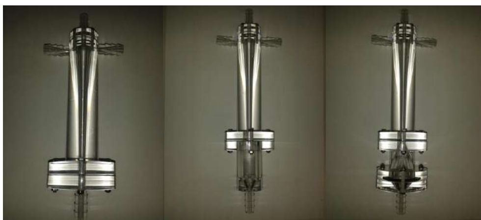
Figura 9 - Configurações do hidrociclone projetado: HC3530, HC3530-A e HC3530-B, respectivamente.
