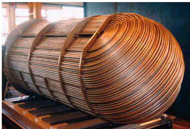
Figura 2-2 - Matriz tubular em forma de "U" separada do casco. (Exinvest do Brasil)
