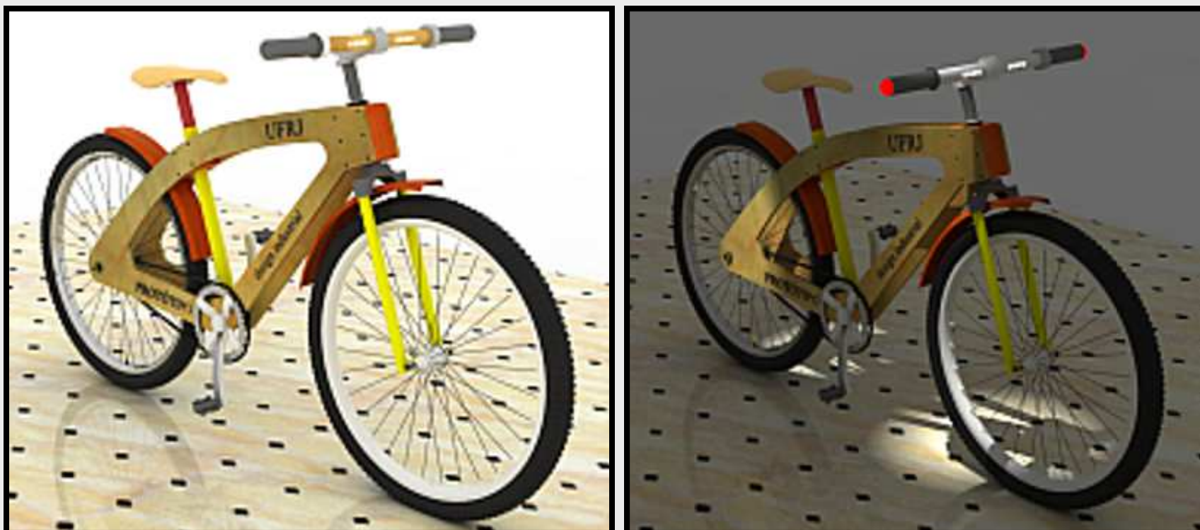
Fig. 2 – Bicicleta elétrica com quadro de madeira laminada reforçada com fibra de carbono
