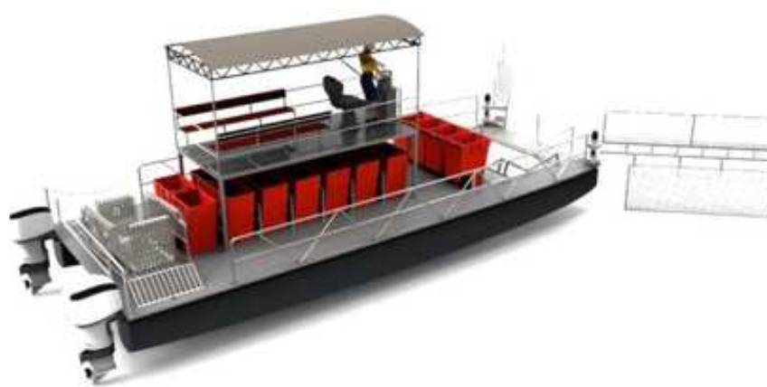
Fig. 6 – Vista em Perspectiva A - Barcode Limpeza de Lixo Flutuante / LABCAD. Fonte:LABCAD / EBA / UFRJ
