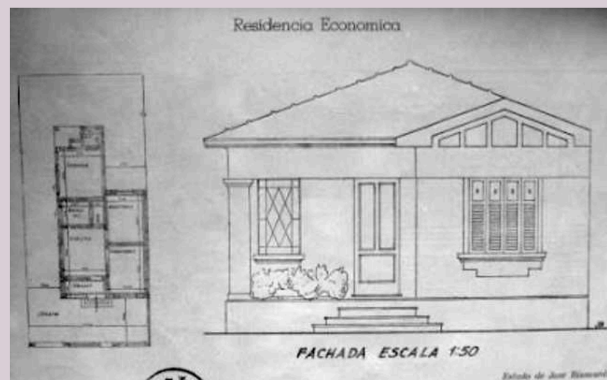
Fig. 2. Estudo de residência econômica de José Biancardi, planta baixa e fachada
