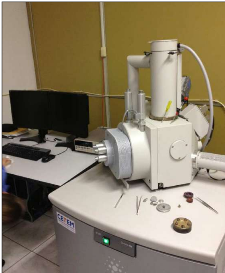
Figura 4 - Microscópio Eletrônico de Varredura (MEV) - FEI Quanta 400.
