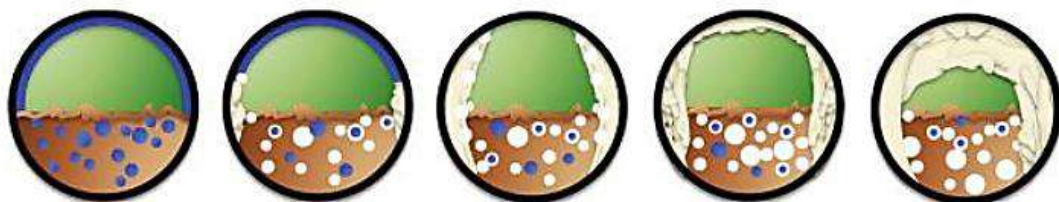
Figura 5 - Ilustração da formação dos clatratos na tubulação do gás natural(JONASSEN, 2013).
