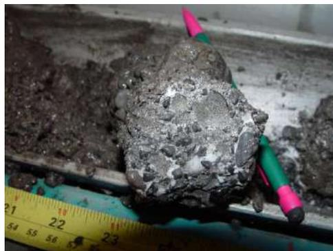
*Figura 2. 4 - Hidrato retirado de tubulação. Fonte: (U.S. Geological Survey 2002)*
