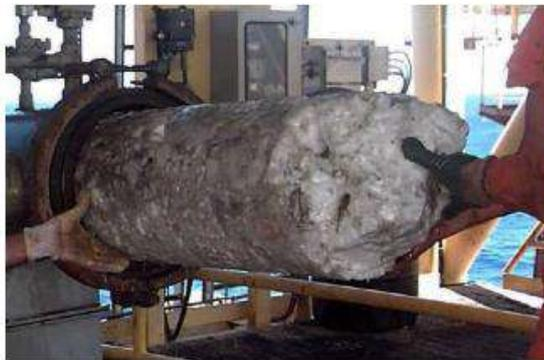
*Figura 2. 3 - Equipamento obstruído por formação de hidratos. Fonte: (Vaz, Maia e Santos 2008)*
