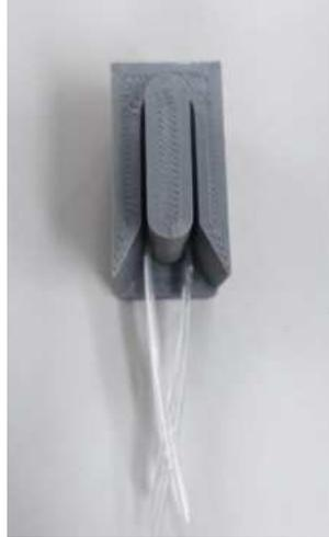
**Figura 5** - Molde para obtenção da fibra em formato de U feito em impressora 3D. Foto autoral.
