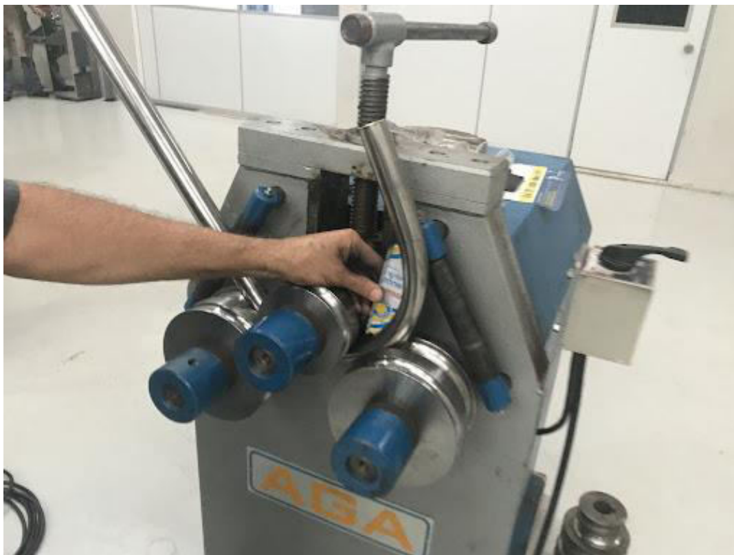
Figura 84: Calandragem de tubo de aço
