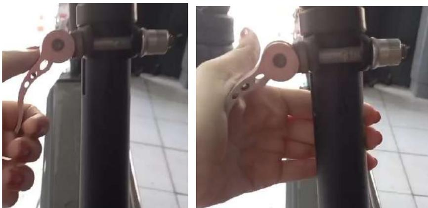
Figura 50 - Teste com o mecanismo Cames em ambiente controlado.
