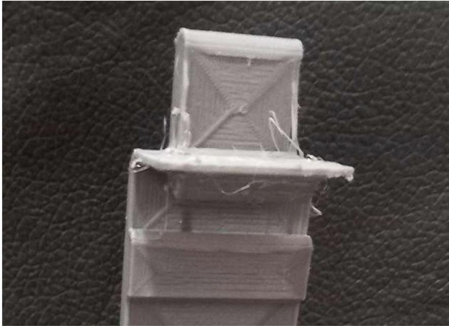
Figura 56 - Falha na região da fechadura, acima da tampa.
