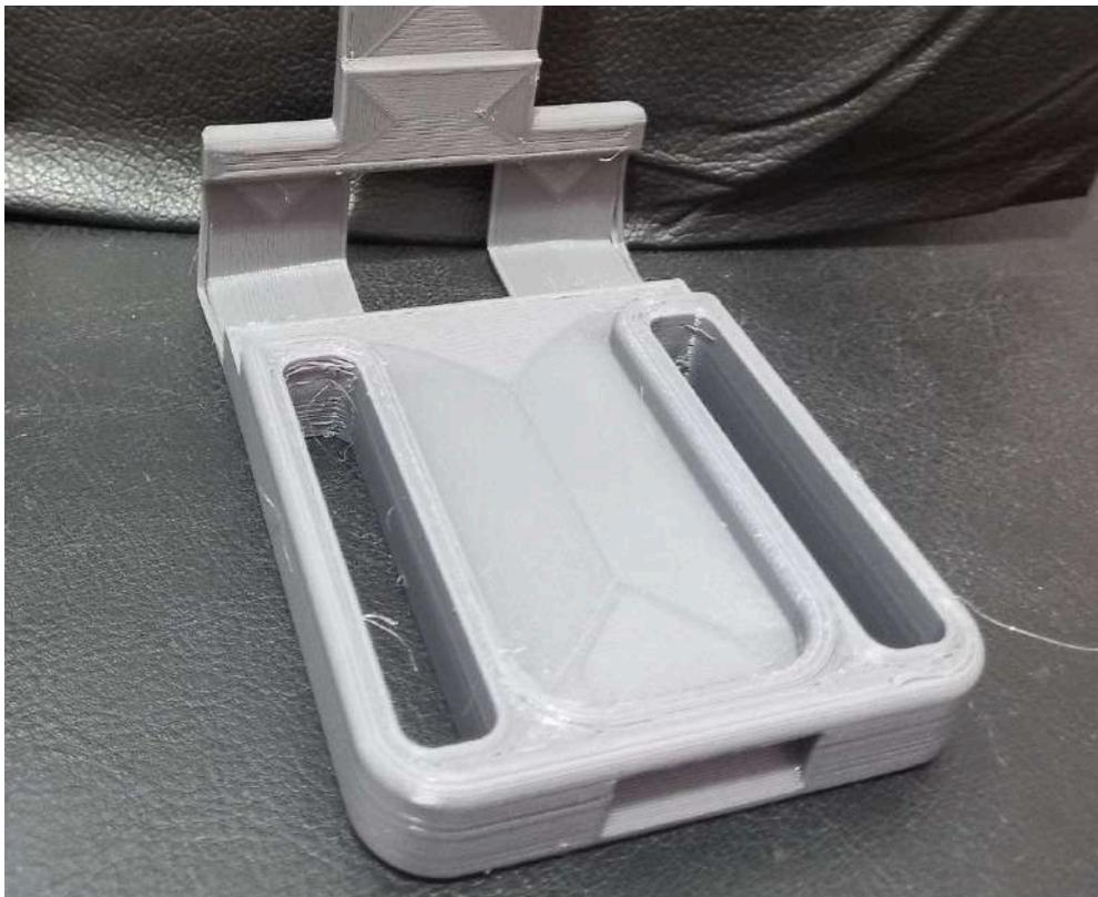
Figura 54 - Falha na dobradiça da alternativa 4.
