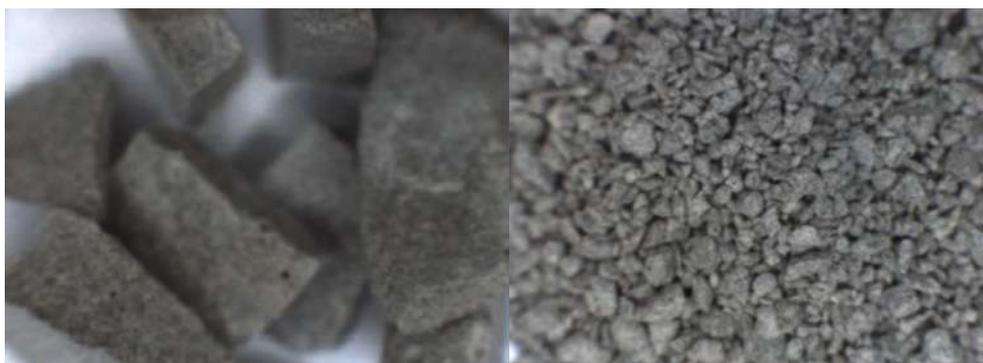
**Figura IV.5** Imagens do cimento hidratado com partículas grossas (2,38 a 4,76mm) e finas (0,15 a 0,71 mm). Aumento de 400x
