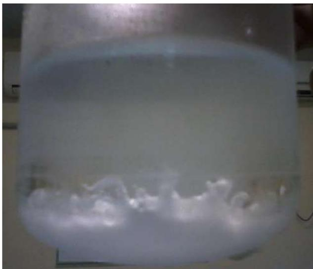
**Figura 23 - Imagem da formação de hidrato de THF em sistema de água e n-heptano.**
