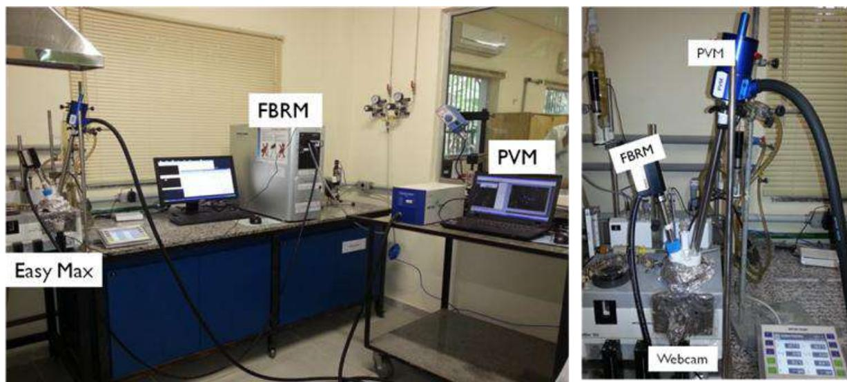
**Figura 14 - Aparato experimental utilizado no NQTR (IQ-UFRJ). Do lado esquerdo da figura está o reator Easy Max e os equipamentos do FBRM e PVM. Ao lado direito evidencia-se o reator Easy Max com a webcam do Master View e as sondas do FBRM e PVM alocadas.**
