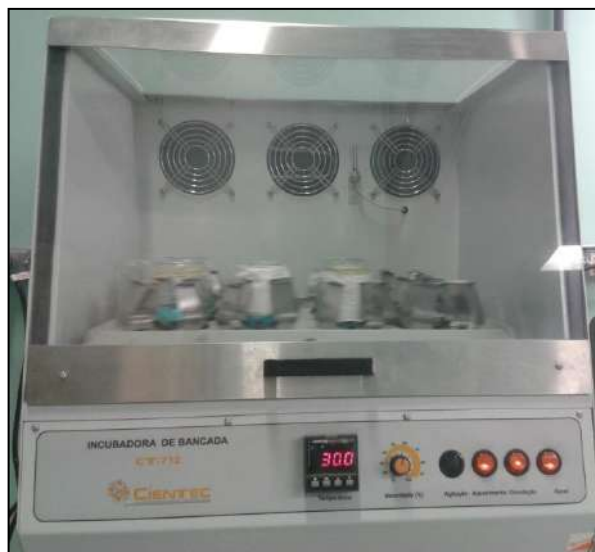
FIGURA 25 – Sistema para a reação da enzima imobilizada com o corante azul de metileno.
