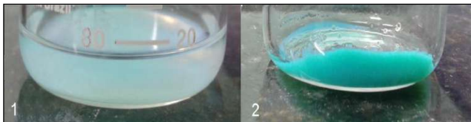
FIGURA 38 - Sistema imobilizado antes (1) e após (2) reação (3h) com azul de metileno e H 2 O 2 em tampão pH 8,0 (amostra 6) após 7 dias da imobilização.
