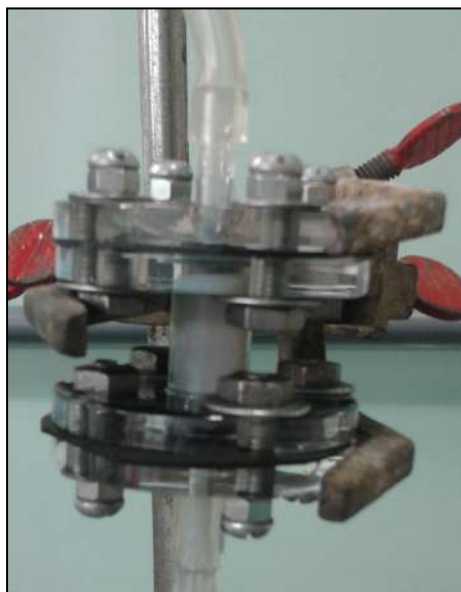
FIGURA 26 - Enzima imobilizada retida no interior do microbiorreator.
