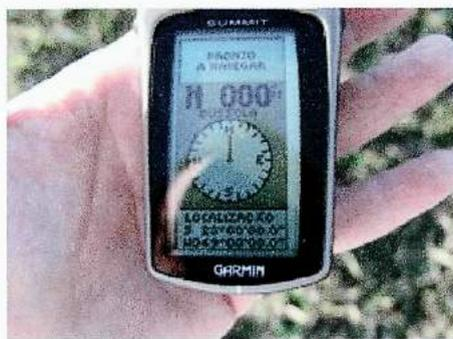
Figura 14. Aparelho de GPS utilizado para determinar as coordenadas de um ponto onde o observador se encontra [19].
