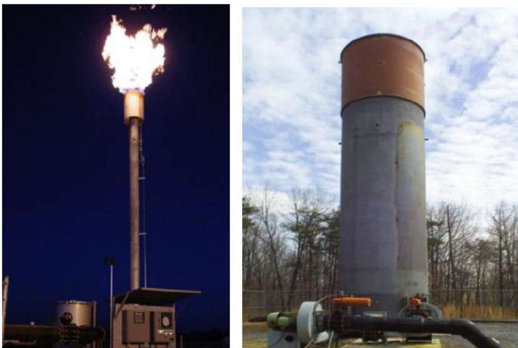
Figura 5 - flare aberto (esquerda) e flare fechado (direita) (EPA, 2015)
