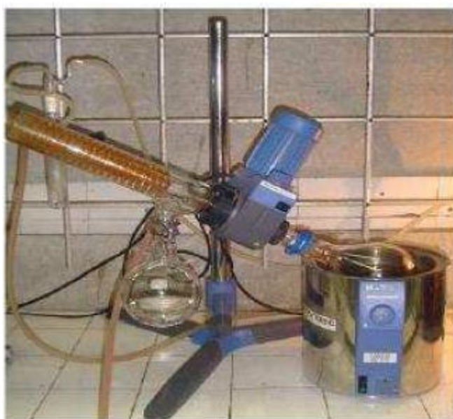
Figura 13 - Evaporador rotatório IKA RV 05 Basic (HONSE, 2011)
