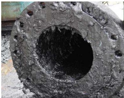
Figura 5 - Tubulação obstruída por asfaltenos (HERIOT-WATT UNIVERSITY, 2008)
