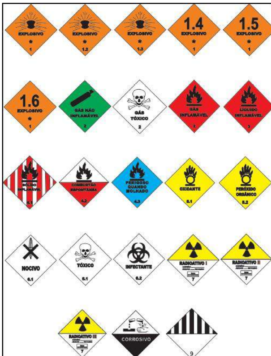
Figura 12– Placas de identificação do carregamento marítimo de mercadorias perigosas.
