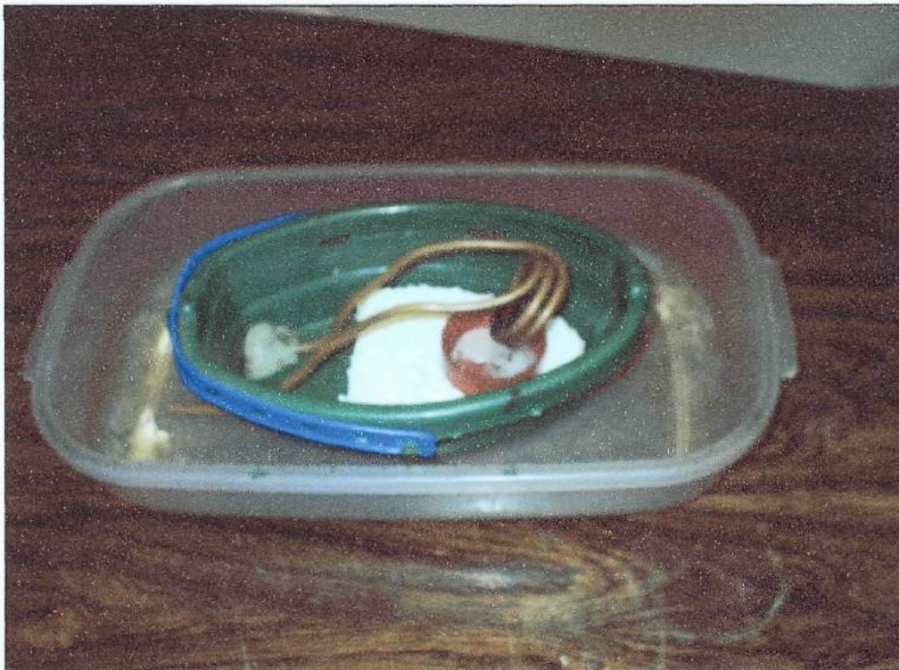
[Figura 9 - Motor a Combustão Externa (Barco pop-pop)]
