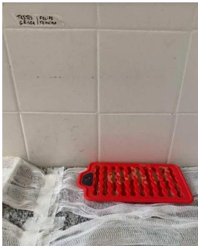
Figura 129- Moldagem do bioplástico em fôrma.
