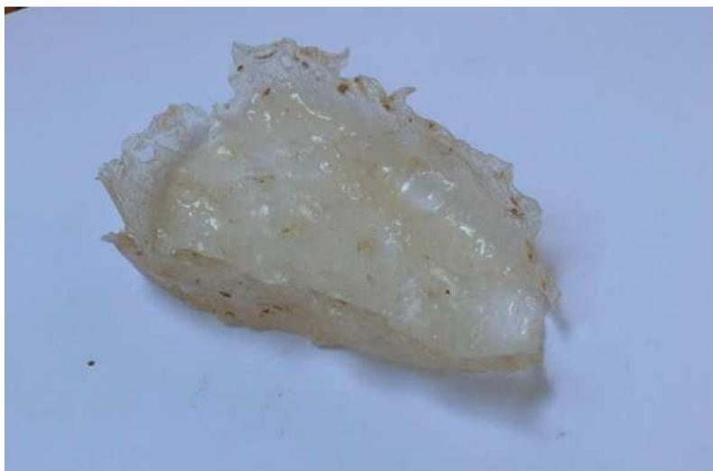
*Figura 121- Resultado do primeiro teste em moldagem no bioplástico de tapioca*
