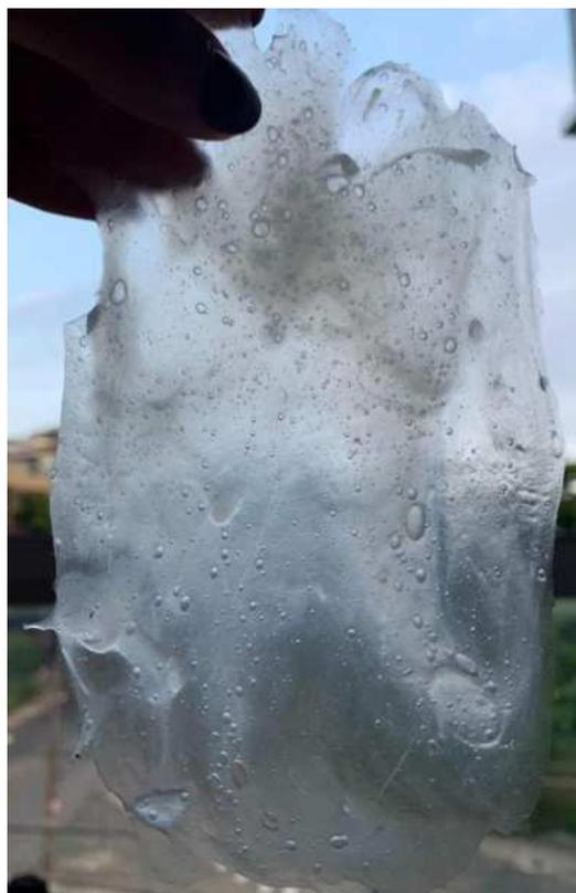
*Figura 119- Detalhe bioplástico de tapioca*
