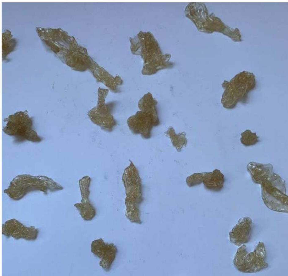
*Figura 114- Teste de produção de bioplástico com agar agar*
