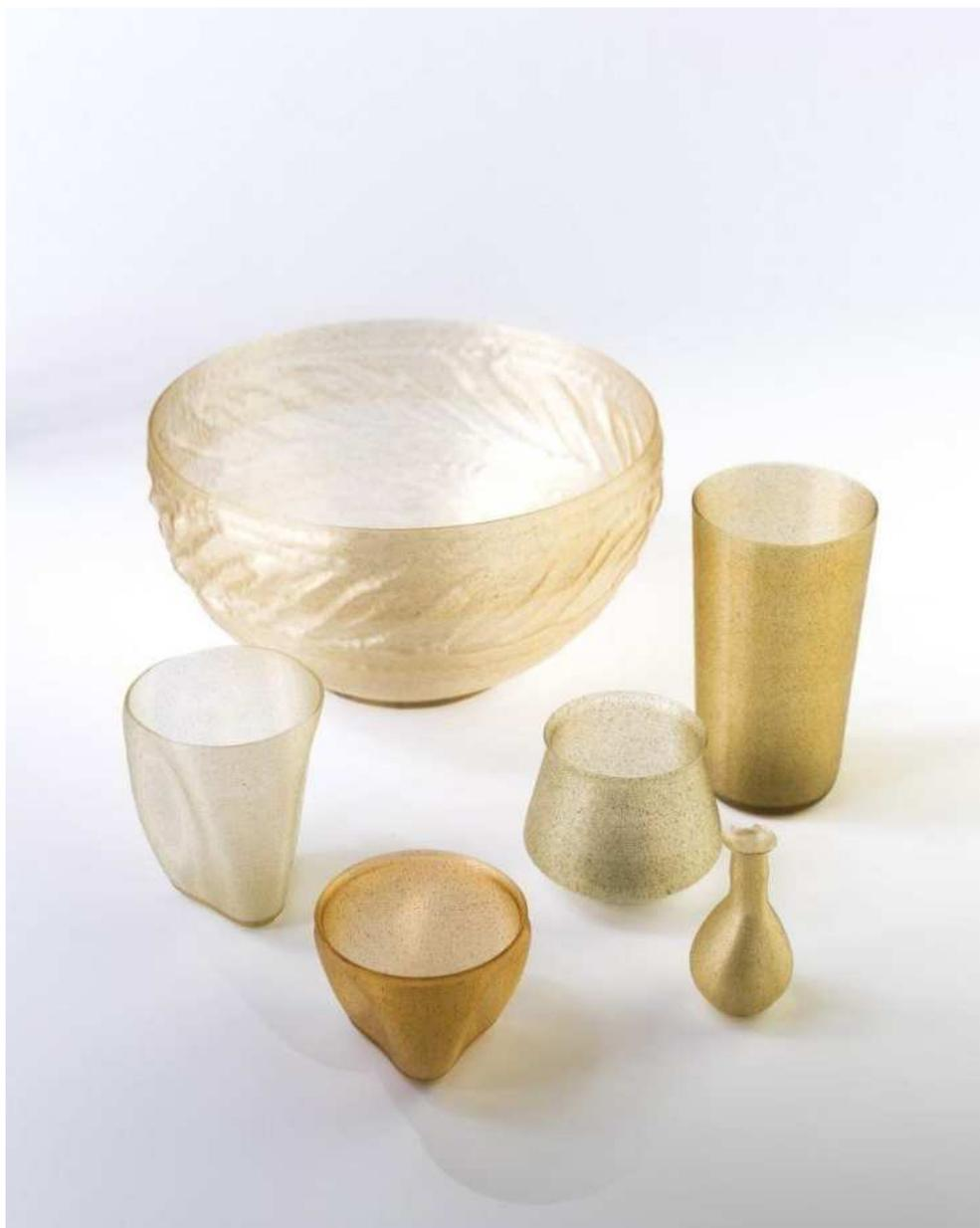
*Figura 110- Conjunto de objetos impressos em 3D com filamento de alga marinha*
