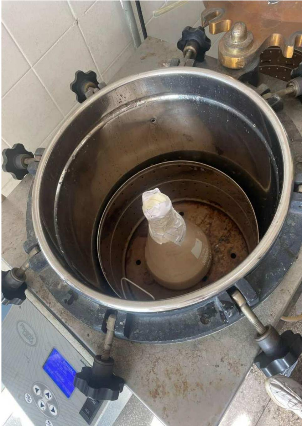
Figura 150- Autoclavagem do material
