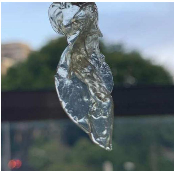
*Figura 113- Teste de produção de bioplástico Agar-Agar.*
