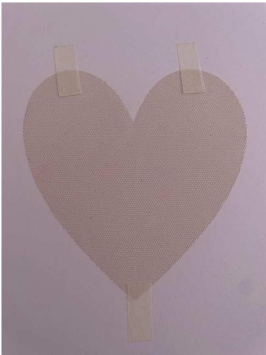
*Figura 203- Teste de corte a laser no tule com forma básica*
