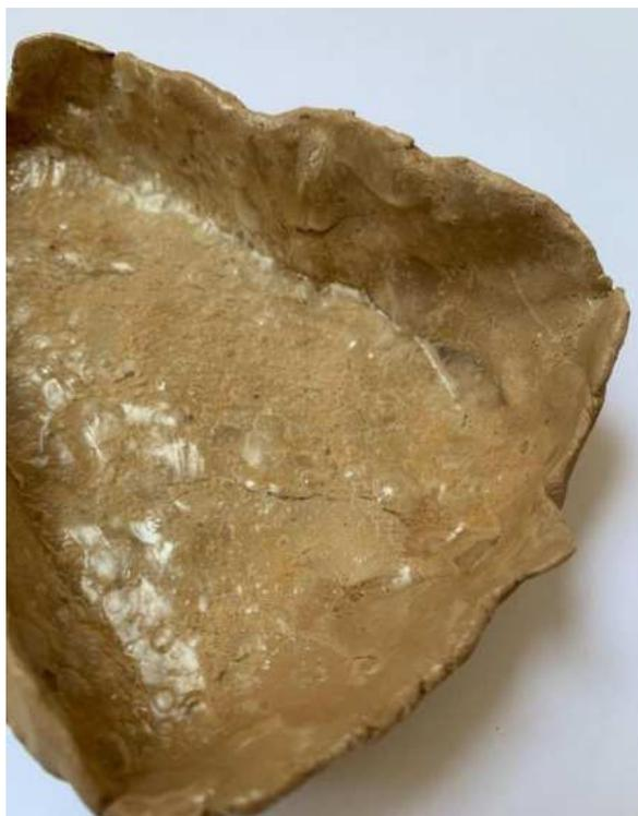
*Figura 120- Teste bioplástico de tapioca em fôrma.*
