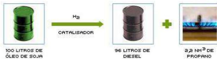
Figura 44 - Rendimento do processo HBIO para a produção de diesel renovável a partir do óleo de soja
