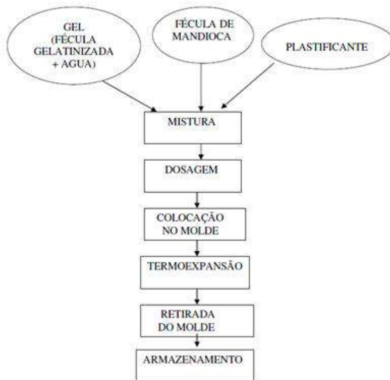
Figura 4.6 - Fluxograma do processo de obtenção de espuma de fécula de mandioca por termoexpansão – Adaptado.
