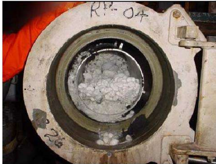
Figura 4: Hidratos formados em tubulação no Campo de Namorado, Bacia de Campos.
