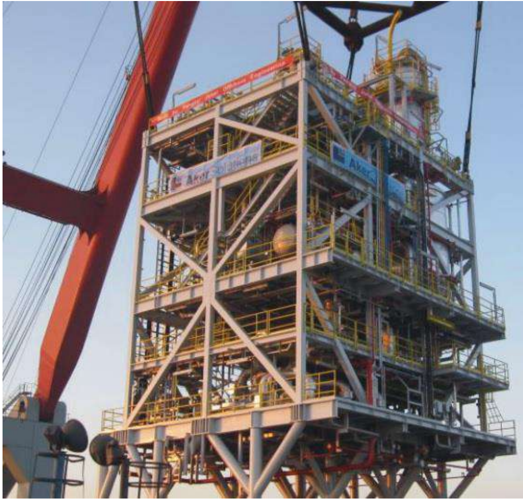
Figura 18: Módulo Full-Reclamation de Recuperação de MEG construído para ser operado no Brasil. Fonte: Aker Solutions, 2010
