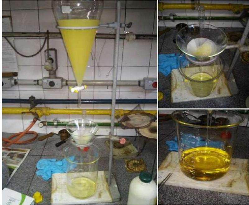
**Figura 9 - Secagem do biodiesel metílico**
