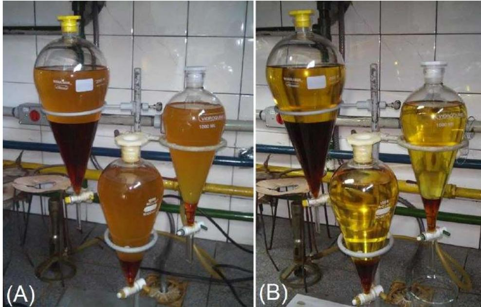
**Figura 8 - Mistura reacional antes (A) e depois (B) do tempo de separação das fases.**
