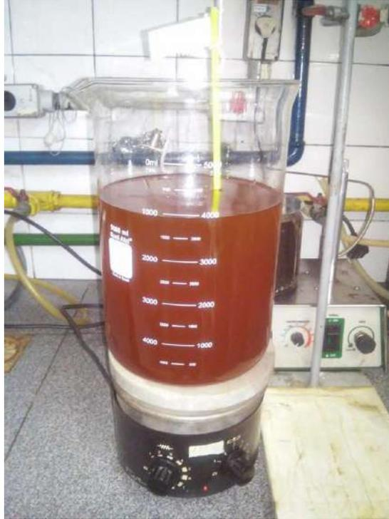
**Figura 7 - Síntese do Biodiesel metílico**
