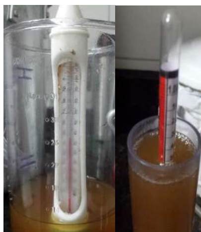
Figura 27: A medição de temperatura e gravidade específica (Fonte: Autor).
