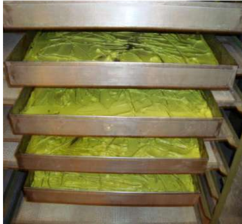
Figura 5 – Secador de bandejas usado na desidratação dos abacates processados
