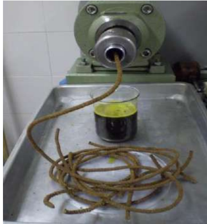
Figura 7 – Prensagem para extração do óleo de abacate
