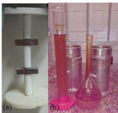
Figura 5.10: Montagem do ensaio na autoclave: (a) CP's na base de teflon; (b) autoclaves e soluções teste.
