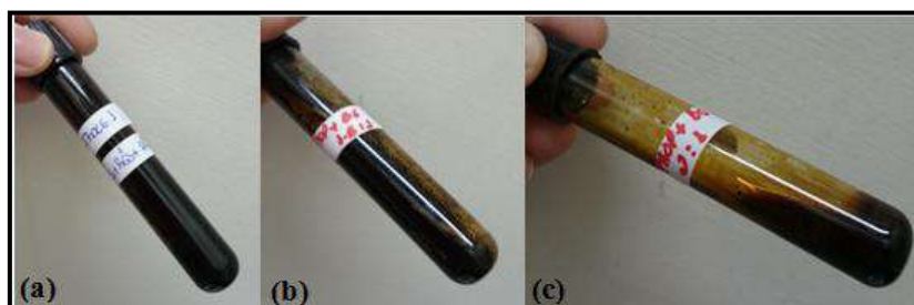
Figura 6.9: Ensaios de interação do resíduo com misturas de solventes:(a) proporção de 1:1:1; (b) proporção de 1: 1.5: 1.5; (c) proporção de 1:2:2.
