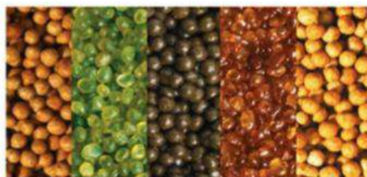
Figura 2.2: Diferentes tipos de materiais de sustentação (RAJEEV, 2012).
