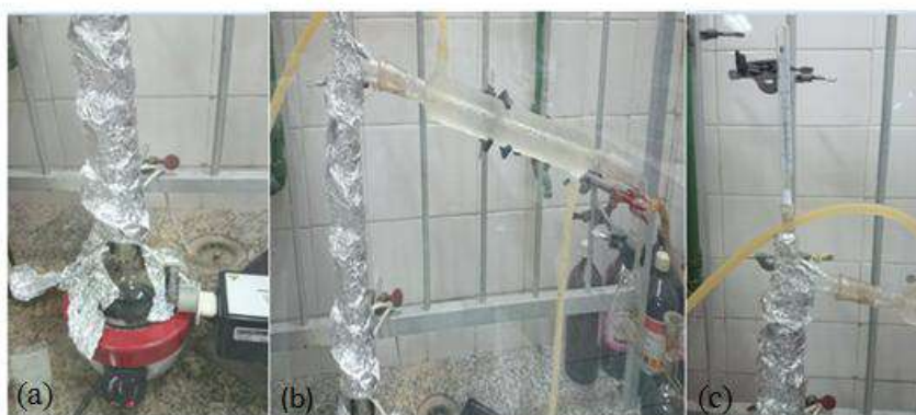
Figura 5.7: Aparelhagem de destilação: (a) Balão na manta de aquecimento; (b) Coluna de destilação e condensador; (c) Termômetro.
