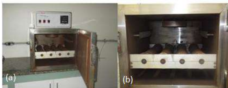
Figura 5.4: (a) Estufa de rolos; (b) parte interna mais detalhada.
