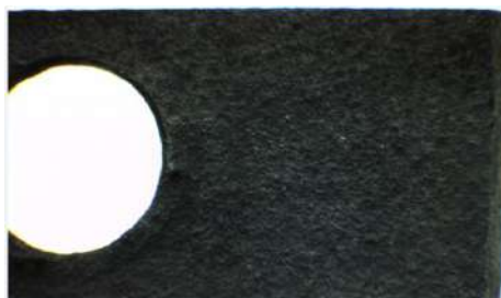
Figura 6.24: Corpo de aço carbono em ensaio a 80°C meio inorgânico com inibidor CH2.
