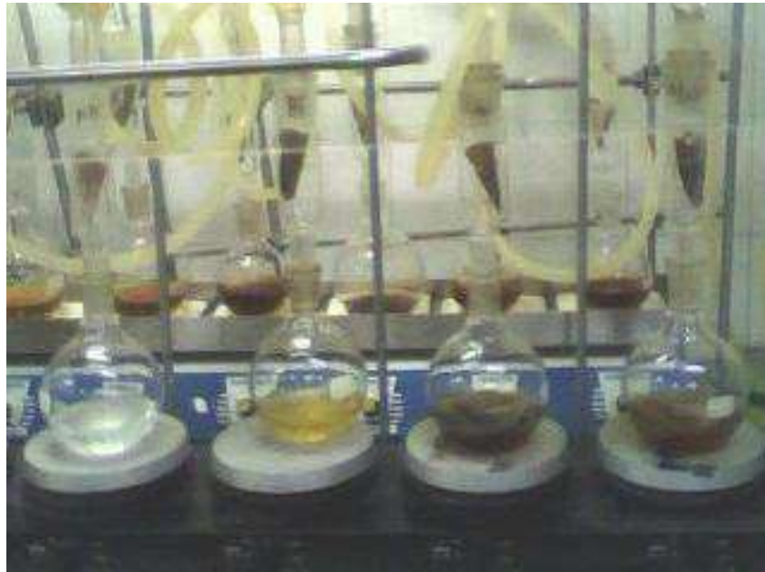
Figura III.3 - Segunda etapa de extração com n-heptano durante extração por método IP-143.
