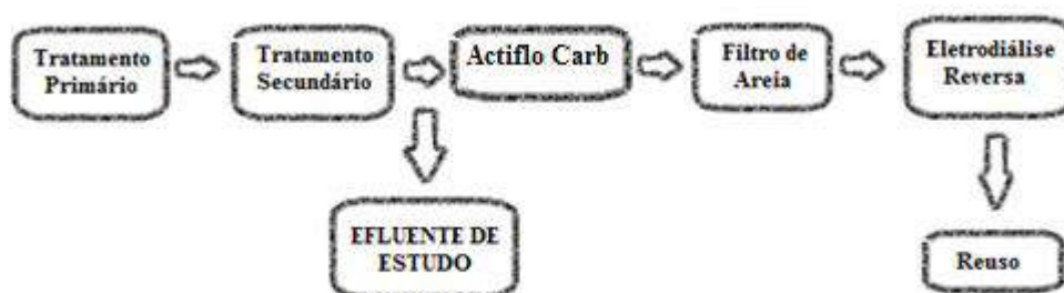
Figura IV.2: Esquema do tratamento proposto e o efluente usado neste estudo.
