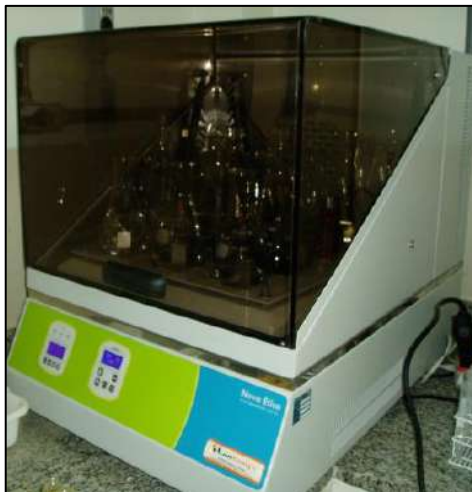
Figura IV.3: Ensaio de isotermas de adsorção do CAP virgem.
