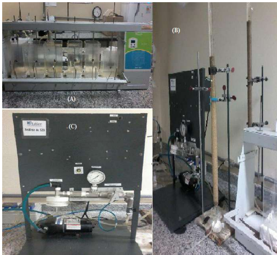
Figura IV.5: Equipamentos utilizados nos experimentos, sendo eles: (A) Jar Test, (B) Filtro de Areia e (C) Equipamento de microfiltração SDI.
