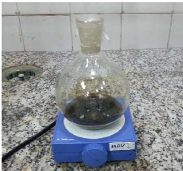
**Figura 6- Aparato experimental da extração pelo método EQ/NP<sub>2</sub> (SILVA, 2013).**
