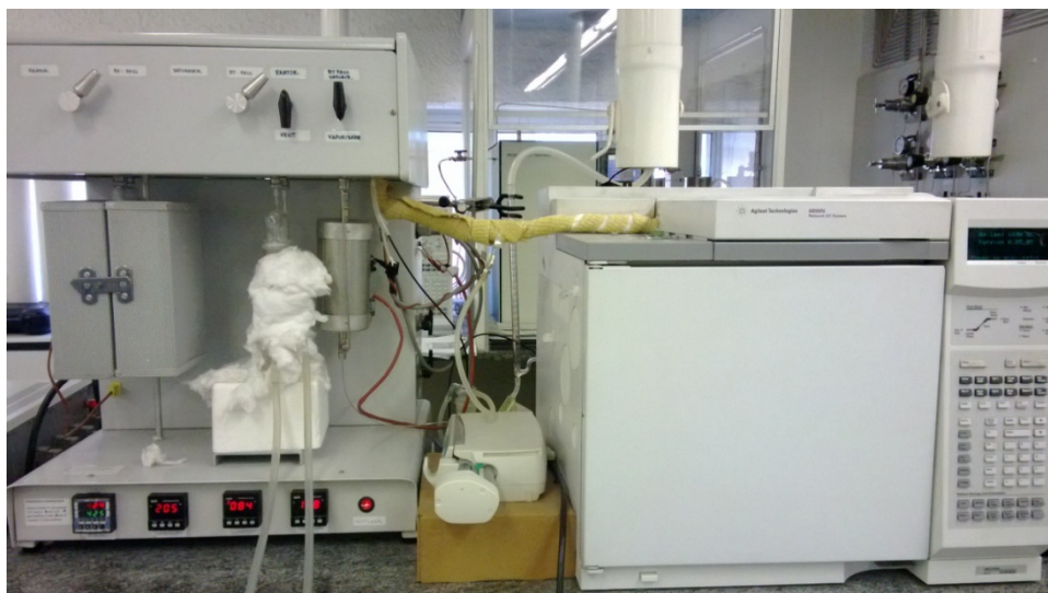
Figura 3.2. Unidade de testes catalíticos.
