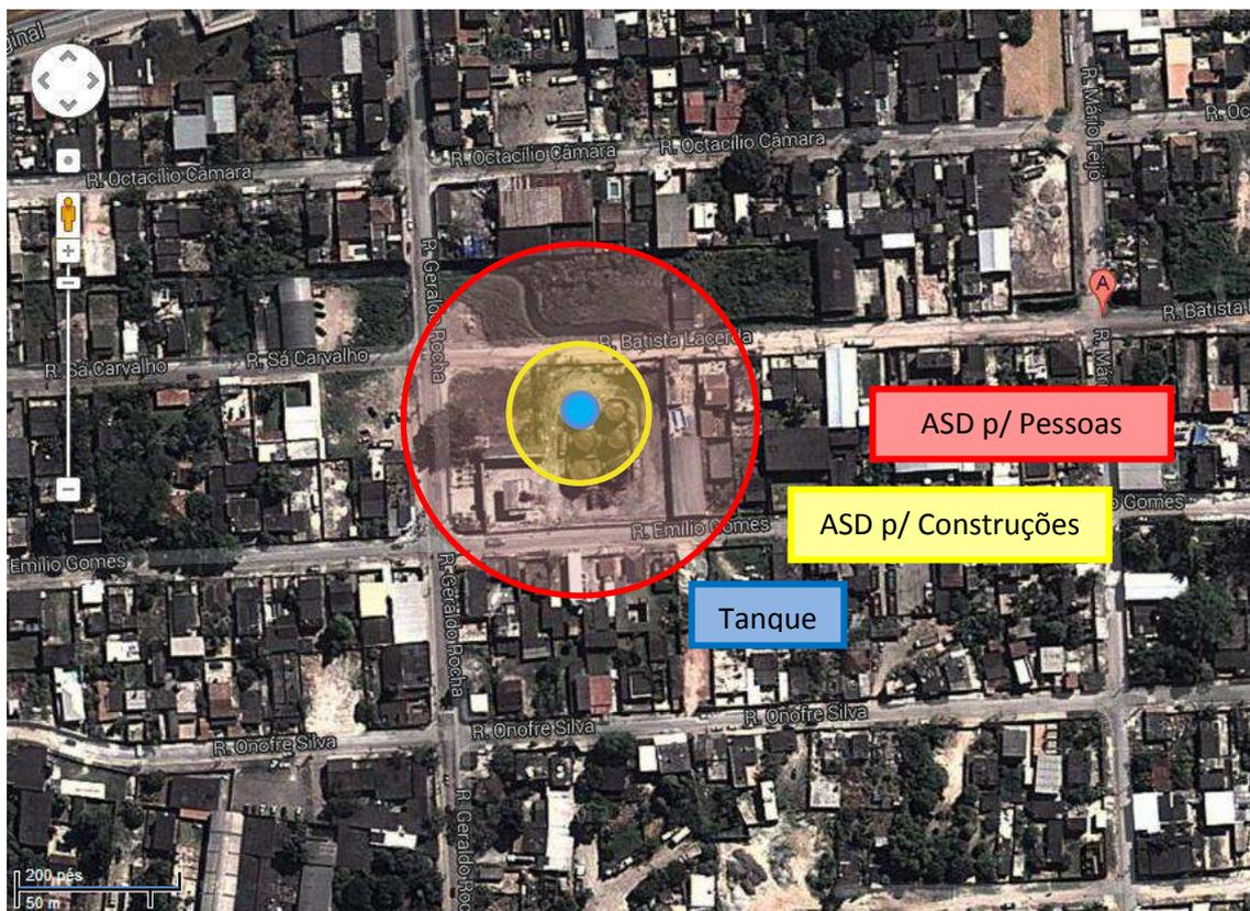
**Figura 15 – Afastamento recomendado para Incêndio no Tanque. Fonte: Adaptado de Imagens ©2013 DigitalGlobe, Dados cartográficos ©2013 MapLink**
