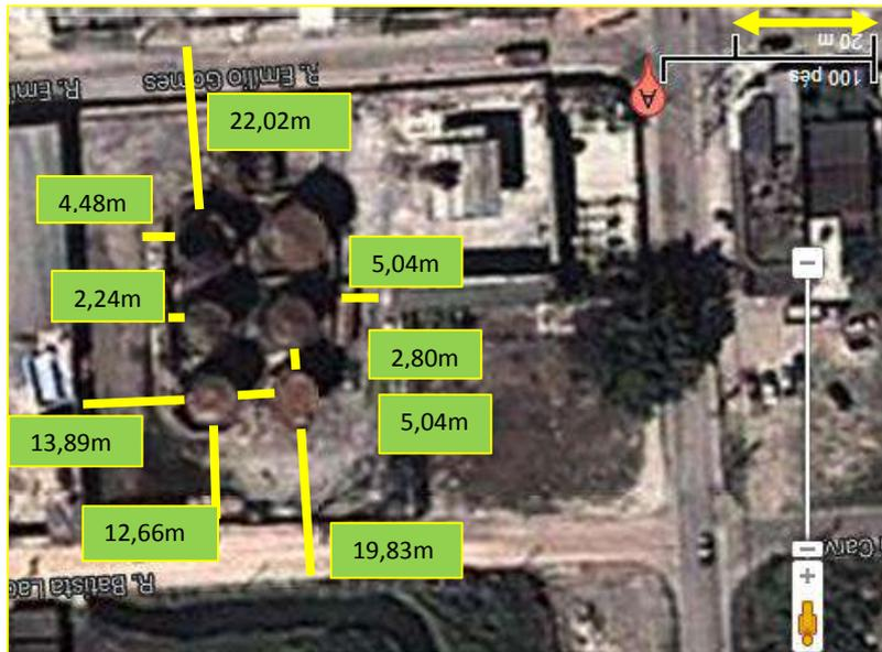
**Figura 31 - Afastamentos no Parque de Tanques da Petrogold. Fonte: Adaptado de Imagens ©2013 DigitalGlobe, Dados cartográficos ©2013 Google, MapLink**
