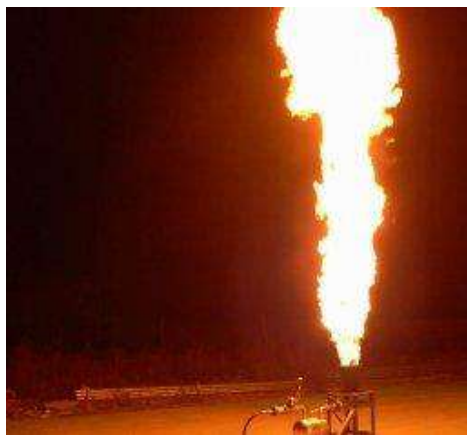
Figura 16 - Incêndio do tipo Jet Fire . Fonte: Industrial Gasburner , 2013.
